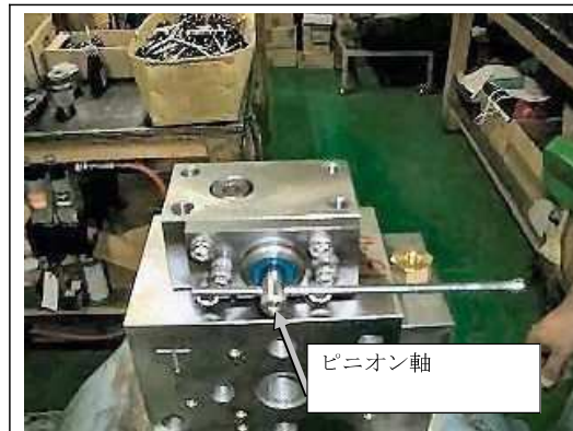
【19】どうしてもうまく噛み合わない時は、ピニオン軸を180°回してから【15】の作業試してください
