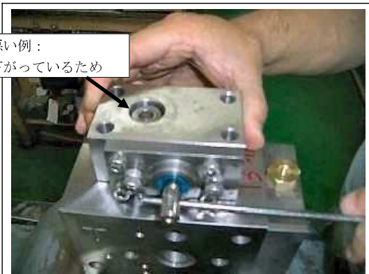
【17】丸棒が水平になったときにスプールの上面がヘッド部の上面にぴったりと水平になるようにする
